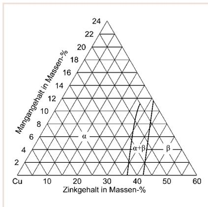
**Bild 6:** Cu-Zn-Mn Isothermer Schnitt bei 500°C (DKI 1920) [5]
