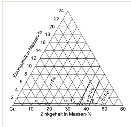
**Bild 7:** Cu-Zn-Fe Isothermer Schnitt bei 500°C (DKI 1921) [5]
