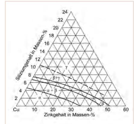
**Bild 4:** Cu-Zn-Si Isothermer Schnitt bei 500°C (DKI 1915) [5]
