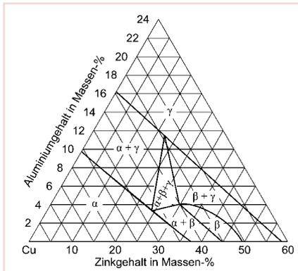
**Bild 2:** Cu-Zn-Al Isothermer Schnitt bei 500°C (DKI 1912) [5]
