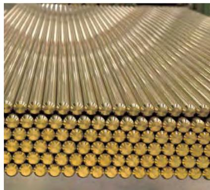
**Bild 20:** Stangen für Kugelschreiberspitzen gefertigt aus Draht CuZn39Pb3
