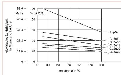
**Bild 8:** Elektrische Leitfähigkeit einiger Kupfer-Zink-Knetlegierungen im weichgeglühten Zustand bei Temperaturen von 20 bis 200 °C (DKI 1812) [9]
