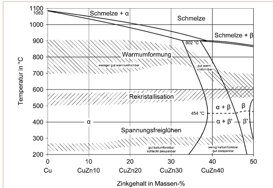
**Bild 19:** Bereiche für Warmumformung, Rekristallisation und Entspannungsglühen von Kupfer-Zink-Legierungen (DKI 1824)
