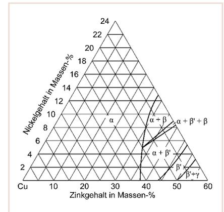
**Bild 5:** Cu-Zn-Ni Isothermer Schnitt bei 500°C (DKI 1916) [5]
